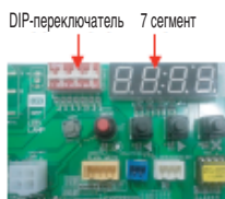
Плата наружного блока
