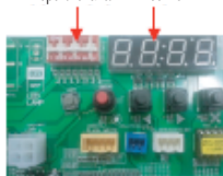
Плата наружного блока
