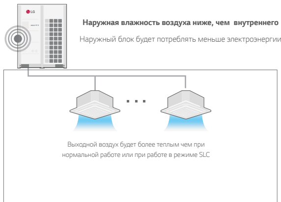
Температура испарения и эффективность Двойной контроль параметров воздуха SLC (Низкая влажность) 30% < относительная влажность < 50%
