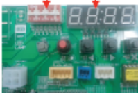
Плата наружного блока
