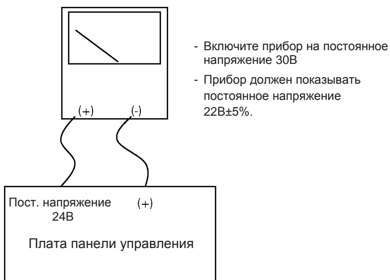
Рис. 75. Схема подключения прибора для измерения напряжения
