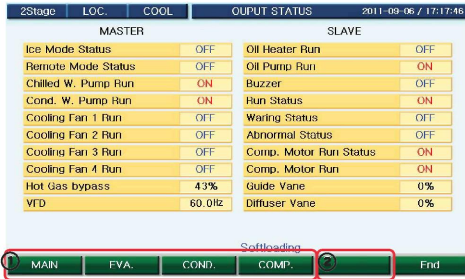
Рис. 36. Окно проверки состояния выходов
